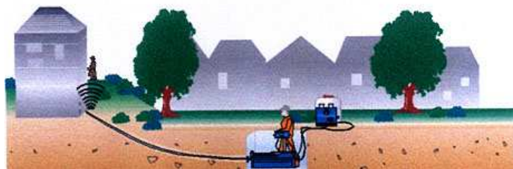
Vyvrtání pilotního vrtu pro domovní přípojku
