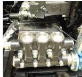
Bentonitové čerpadlo se 400 l/min. dopravní výkon.
