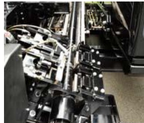
Natočené klemování, aby pozice pro povolení tyčí mohla být z kabiny lépe rozpoznatelná
