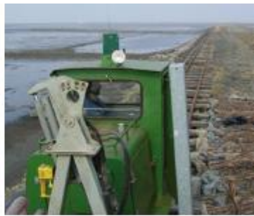
Vozík s GRUNDODRILLEM 4X na cestě k Halligu. Větší vrtací přístroj by se nemohl na Hallig nasadit.
