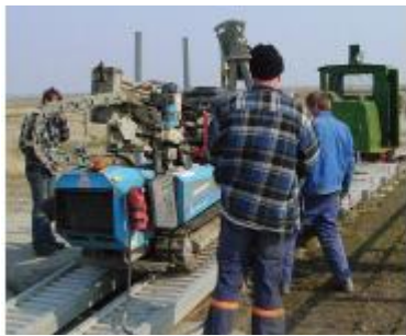
Vozík s GRUNDODRILLEM 4X na cestě k Halligu. Větší vrtací přístroj by se nemohl na Hallig nasadit.
